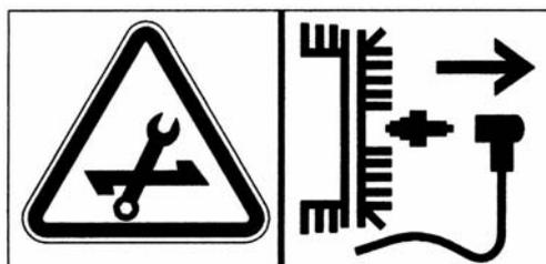
ALWAYS DISCONNECT THE CABLE FROM THE ENGINE SPARK PLUG
